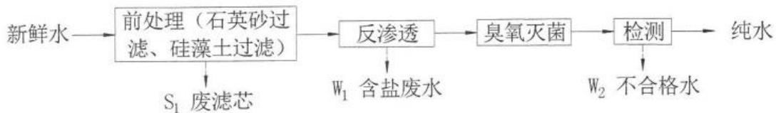
图 3.5-1 纯水制备生产工艺流程及产污环节图
